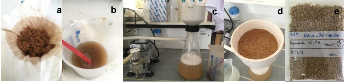
Şekil 3.2. Organosolv sonrası katının enzim hidrolizine hazırlanışı. a: reaktörden çıkan katının tülbent ile süzölmesi; b: Katının su ile yıkanması; c: yıkama suyunun ayrımı; d: ıslak organosolv katısı; e: enzimatik hidrolize hazır öğütölmüş katı.
