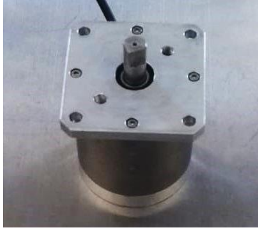
Şekil 3.54. Montajı yapılmış MRS temelli yarı-aktif eyleyici
