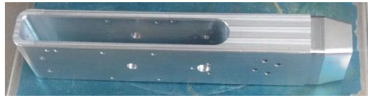
Şekil 3.48. Zemin grubu 4 numaralı parçanın üretimi
