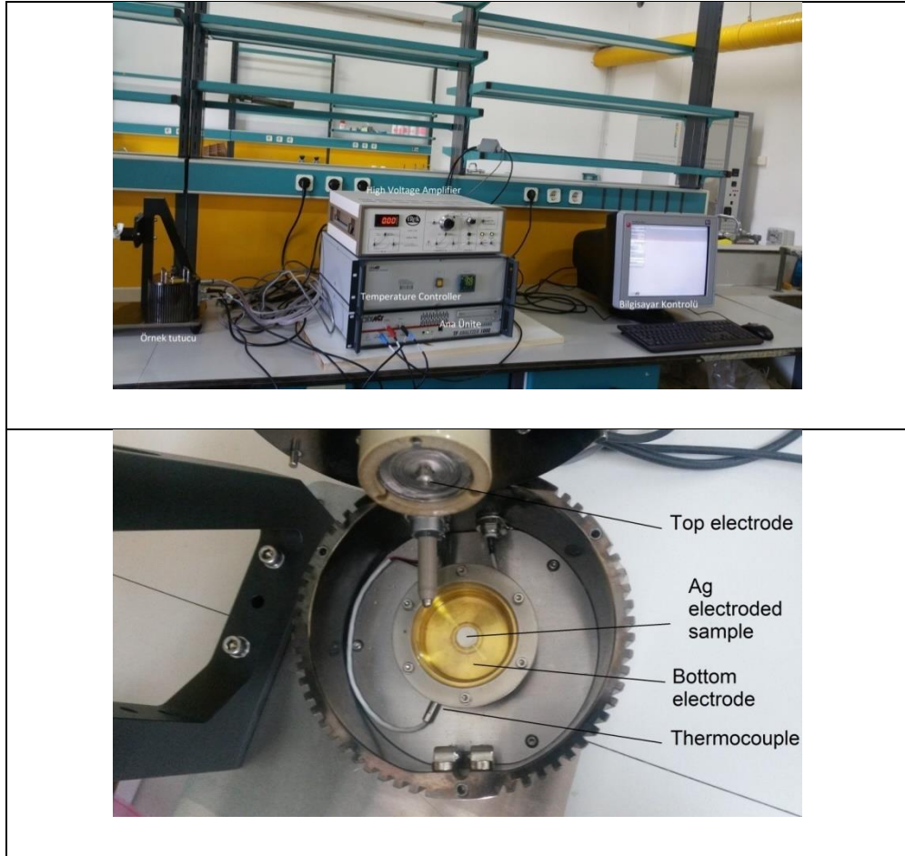
Şekil 7: (Üst panel) Proje kapsamında satın alınan Aixact TF1000 cihazının görüntüsü. (Alt panel): TF1000'in örnek tutucusu.
