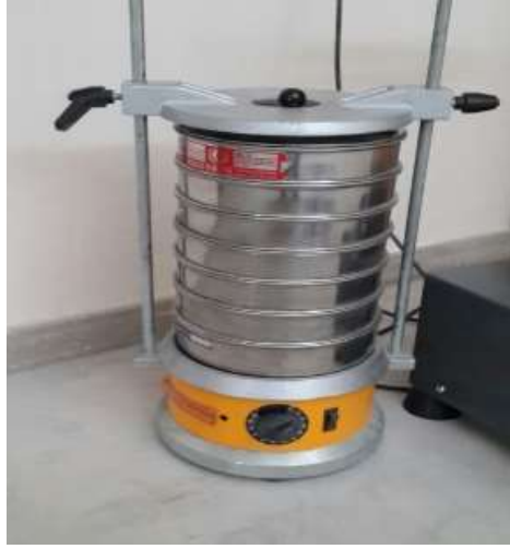
Şekil 7. Deneylerde kullanılan elek seti
