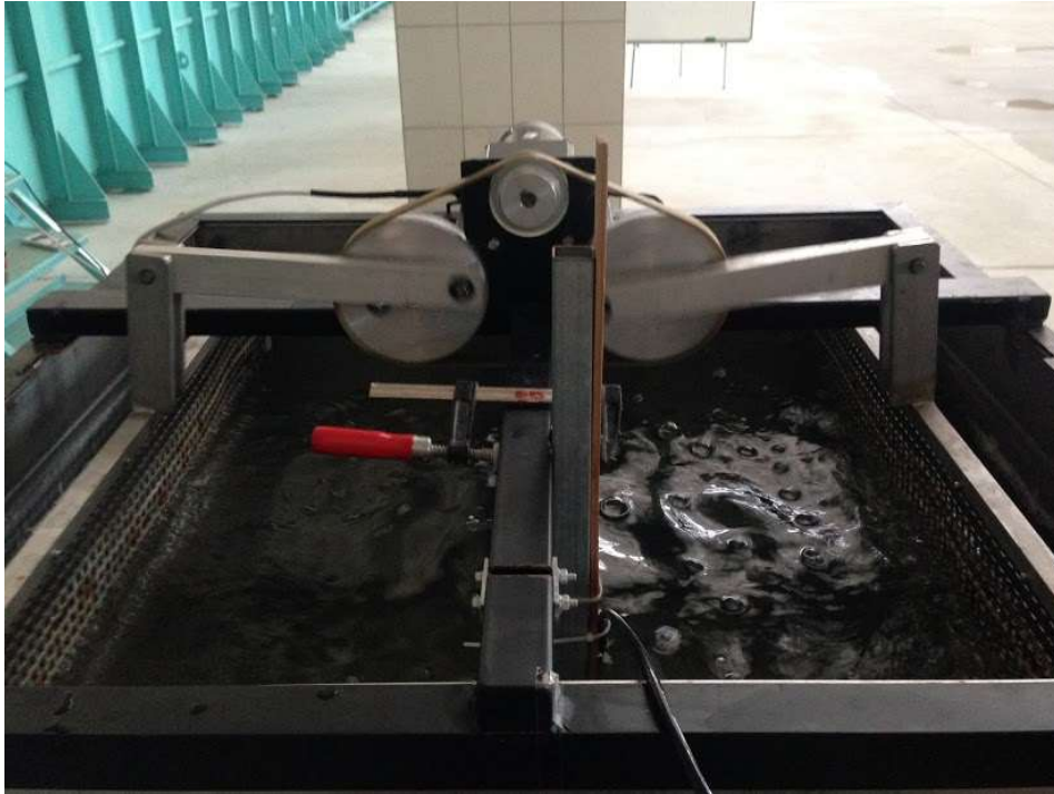
Şekil 5. Türbülanslı akımı oluşturan motor sistemi a) dışarıda b) su tankında monte edilmiş hali
