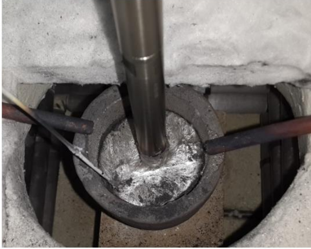
Şekil 3.7. Ultrasonik proses sonrası kapsül mekanizması ile takviye edilmeye çalışılan GNL'ların (Siyah oklar ile gösterilmektedir) matris yüzeyindeki görüntüsü
