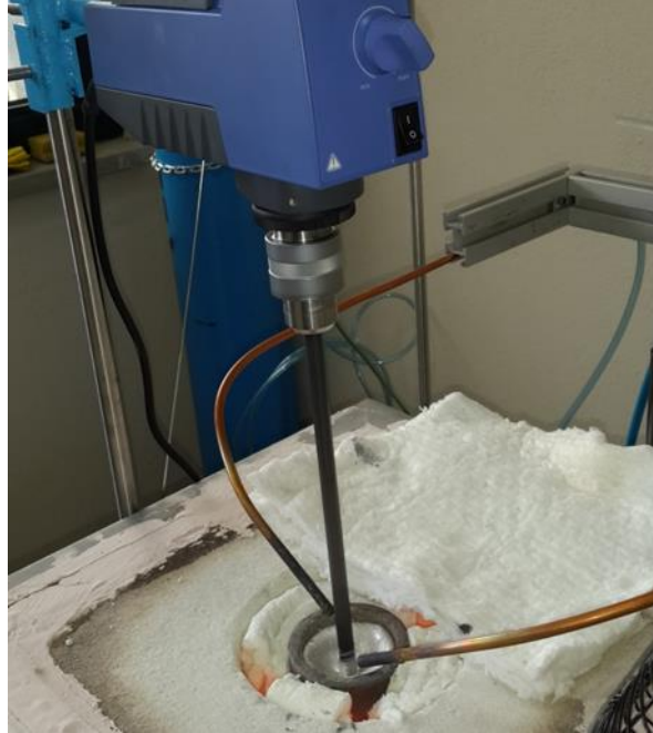
Şekil 3.9. GNL'ları içeren tabletlerin A360 alaşımı içinde mekanik mikser ile karıştırılması/dağıtılması
