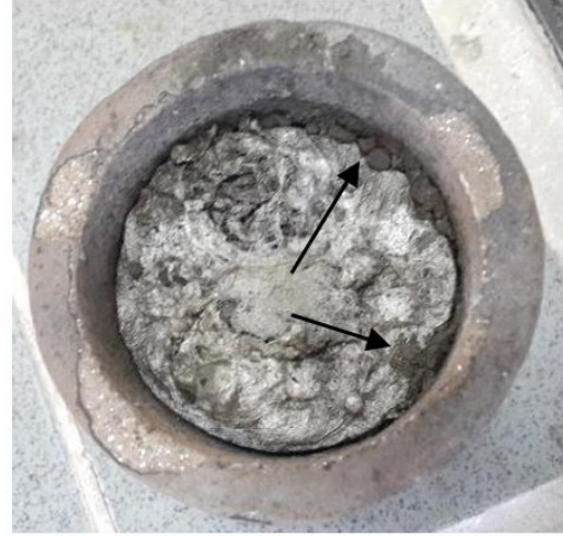
Şekil 3.7. Ultrasonik proses sonrası kapsül mekanizması ile takviye edilmeye çalışılan GNL'ların (Siyah oklar ile gösterilmektedir) matris yüzeyindeki görüntüsü
