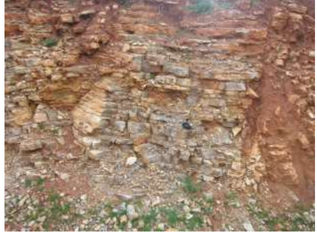
Şekil 8.8. İldırı çevresinde karbonatlı kayaçalarda gelişen çatlaklar
