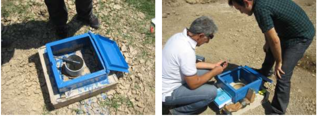
Şekil 3.4. Gözlem kuyularına diver yerleştirilmesi
