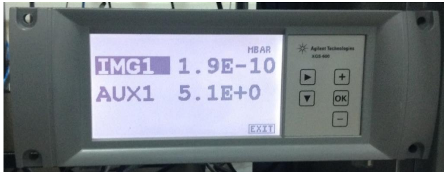
Şekil 4. Fırınlama işlemi tamamlandıktan 24 saat sonrasında Varian IMG-300 (şekilde IMG1 olarak kodlu) vakum ölçer ile ölçülen çember basınç değeri. 5 \times 10^{-9} mbar basınç seviyesinin altındaki değerler Varian FRG-700 Cold Cathode (şekilde AUX1 kodlu) vakum ölçerin çalışma aralığı dışında kalmaktadır. Bu nedenle kontrolcü Varian FRG-700 için doğru bir ölçüm sonucu göstermemektedir.
