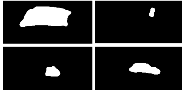
Şekil 3. Tümyönlü kameradan arkaplan çıkarımı ve morfolojik işlemler sonucunda elde edilen silüet örnekleri. Az yer kaplaması için tümyönlü imgede ilgili yer kesilmiştir. Sol-üst: dolmuş silüeti, sağ-üst: yaya, sol-alt: motor, sağ-alt: araba.
