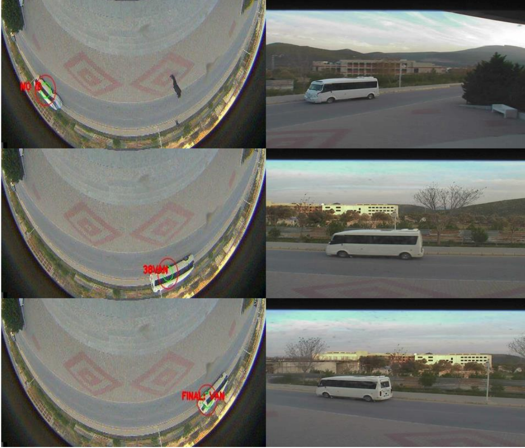
Şekil 15. Hibrit sistem ile dolmuş takibine bir örnek
