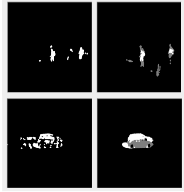
Şekil 10. Sol sütunda görülen silüetler ABL algoritması, sağ sütunda gösterilenler ise MOG2 arkaplan çıkarımı algoritması [13] ile PTZ kameradan elde edilmiştir.
