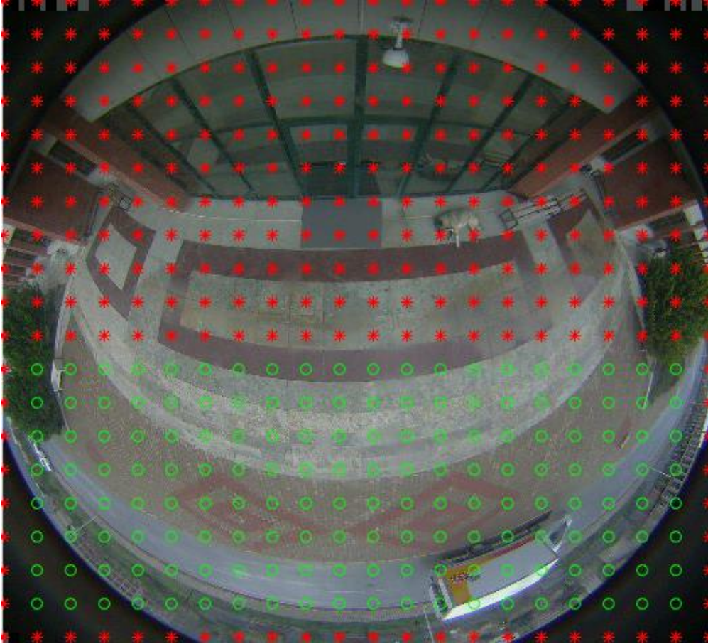
Şekil 12. Tümyönlü kameradaki ızgara deseni noktaları. Kırmızı noktalar PTZ kameradan görünmediği ya da ilgi alanımıza girmediğinden sadece yeşil noktalara denk gelen pan/tilt açıları kaydedilmiştir.
