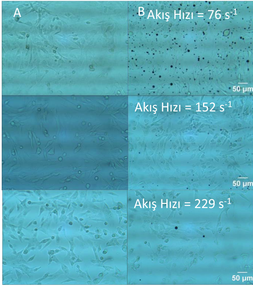
Şekil 234. (A) Hücrelerin yapışma deneyindeki önceki ilk görüntüleri ve (B) 2:5:3 DSPC:PEG40St:DSPG formülasyonu ile üretilen EGF içeren mikroköpükçüklerin farklı akış hızlarında hücre yüzeyine bağlanma görüntüleri
