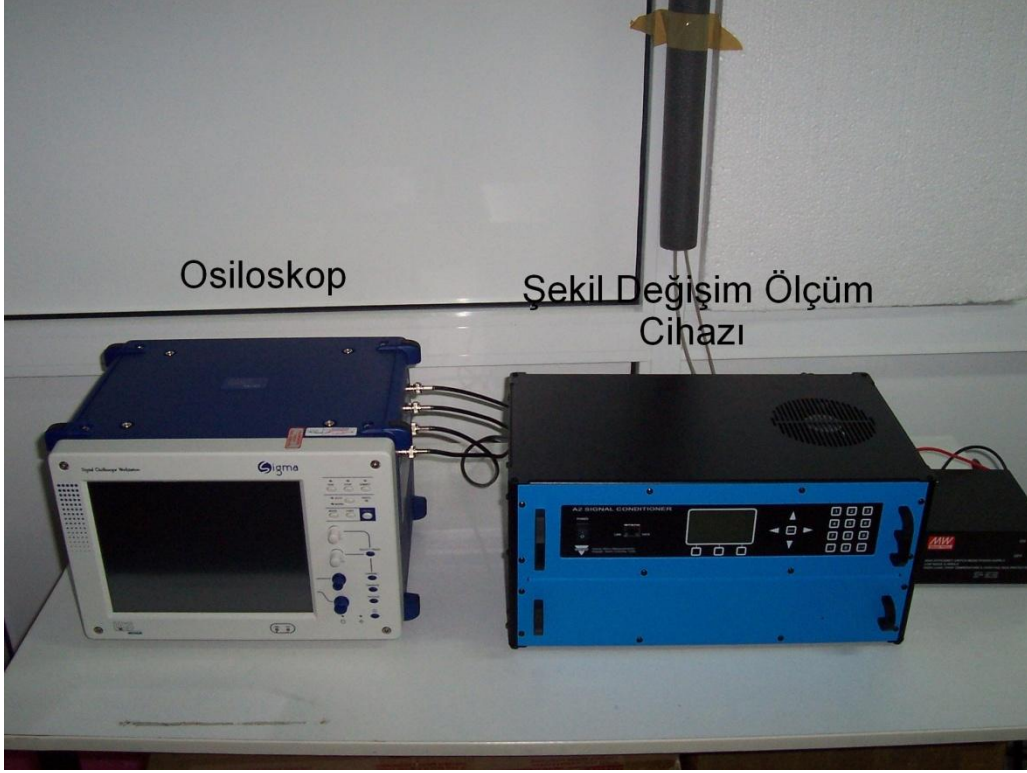
Şekil 2.10 Osiloskop ve şekil değişim ölçüm cihazı.
