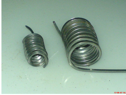
Şekil 3.2.2 : In-situ olarak üretilmiş %5 SiC + %95 (Mg+2B) bobinlerin tavlamanmadan önce, görüntüleri
