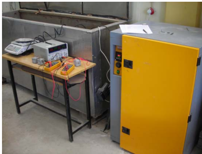
Şekil 3.18. Nem düzeltmelerinin belirlenmesi için a) Elektrik devresi b) Voltaj ölçümü c) Deney ekipmanı (fırın-tartı-doğru akım güç kaynağı- voltmetreler).
