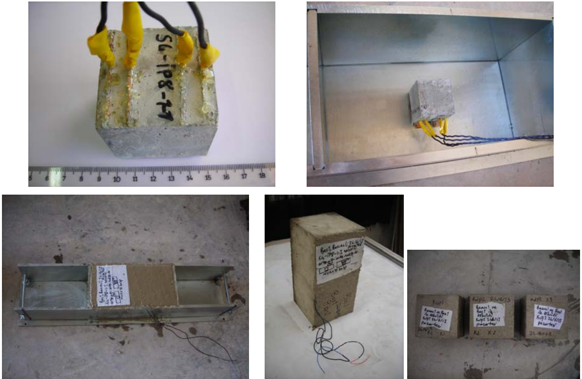
Şekil 3.22. a) ÇES elektrotları izole edildi b) ÇES model kolon kalıbı içinde c) Model kolon kalıbına beton döküldü d) İçinde ÇES olan model kolon e) 15 cm ebatlı küp örnekler.
