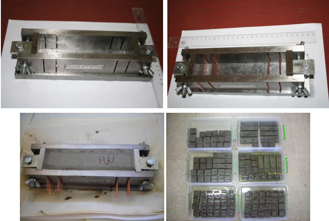
Şekil 3.13. 4*4*16 cm ebatlı küp kalıp. a-b-c) Bakır elektrotlar ve özel kalıp. b) Karışım döküldükten sonra d) Örnekler kür olurken.
