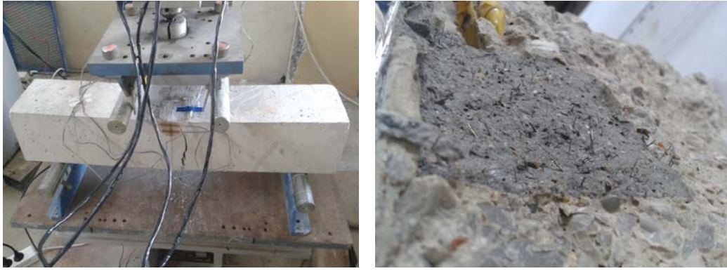
Şekil 4.21 Kiriş eğilme testinde ÇES üstte basınç bölgesinde a) Kiriş kırılmış b) ÇES içindeki çelik lifler.
