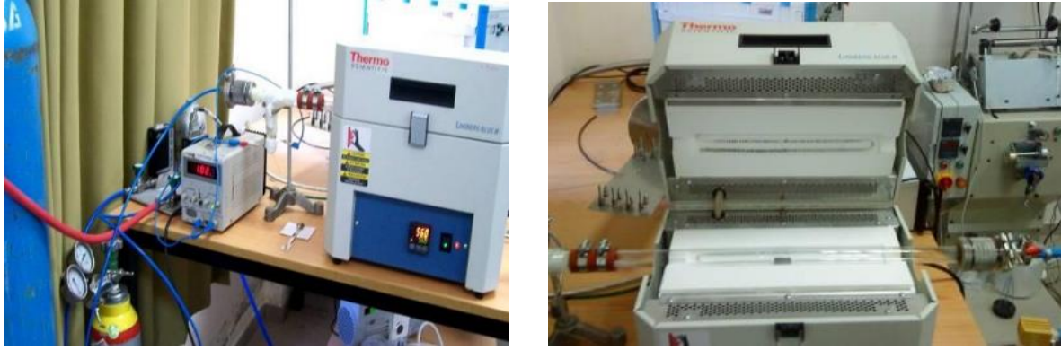
Şekil 12. Projemizde kullandığımız sülfürizasyon sistemi
