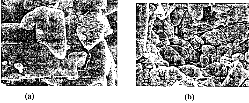
Şekil 4.2.2: Üretilmiş olan MgB_2 'ün a) toz halindeki b) tablet halindeki SEM fotoğrafları
