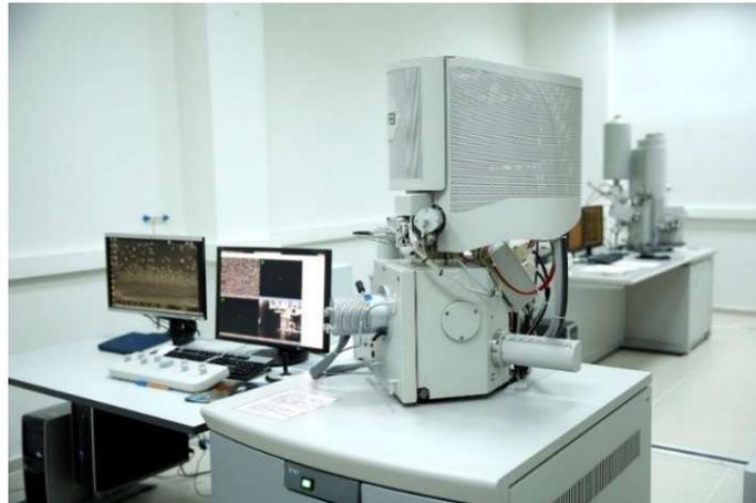
Figure 26. FEI-SEM device
