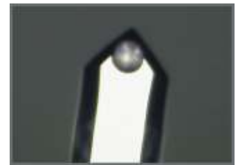
Standart Kantilever'dan yaptığımız 5 µm boyutundaki bir Kolloid Prob
