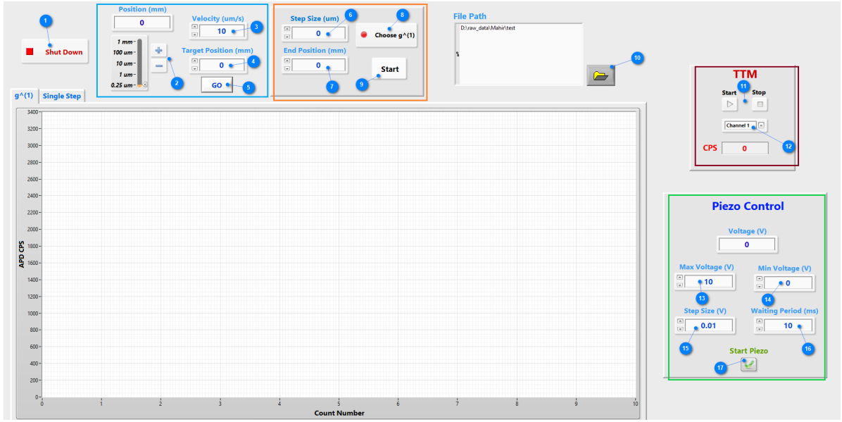
Şekil 32: Michelson interferometresinin otomatize edilebilmesi için geliştirilen Labview arayüzü.
